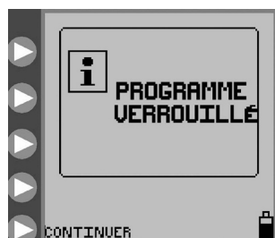
Figure 16. Ecran Programme verrouillé indiquant que la pompe est en mode VERROUILLER PARAMETRES.
